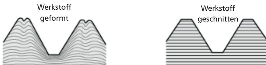
Bild 3: Faserverlauf beim Gewindeformen (links) und Gewindeschneiden (rechts)
