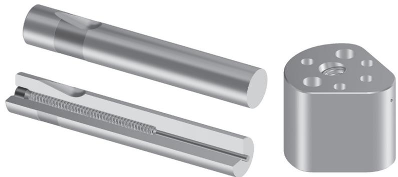
Mittels tränenförmiger Kugelkalotte im Stempelschaft und in der Halteplatte integrierter Kugel sind Schnellwechelscheidstempel einfach und ohne Demontage der Halteplatte auswechselbar. Mit einem speziellen Kugelheber wird der Mechanismus gelöst und der Stempel kann nach unten abgezogen werden.
