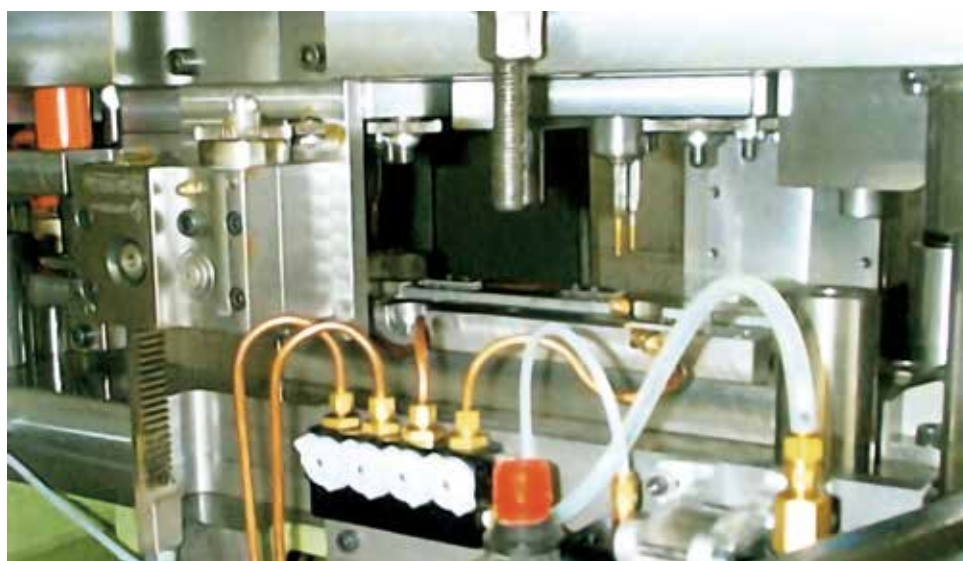
Maschiatrice ribaltata di 180°. Soluzione suggerita per stampi con corse lunghe (oltre 300-350 mm) Tapping unit at 180°overturned. This solution is suggested by dies with long runs (more than300-350 mm) Gewindeformeinheit um 180 Grad. Lösungsvorshlag für Werkzeuge mit langen Hub (More Than300-350 mm)
